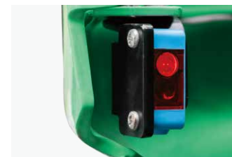
Ein Fußsensor bremsst das Fahrzeug (gegebenenfalls bis zum Stillstand), sobald er feststellt, dass sich ein Fuß des Fahrers außerhalb der Plattform befindet (Fahrermodell)
