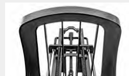
Beim Fahrermodell ist zur Sicherheit ein Fahrerschutzdach angebracht - sollten einmal unerwartet Lasten herabfallen.
